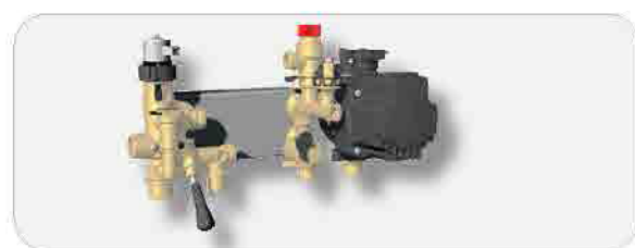
Gruppo idraulico compatto in ottone. Gruppo di mandata con deviatrice motorizzata, by-pass e rubinetto di carico impianto integrati. Circolatore ERP con sblocco pompa manuale su gruppo di ritorno.
