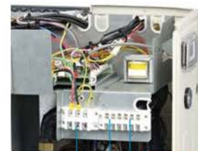
Alimentazione Porta ON/OFF Circolatore esterno
